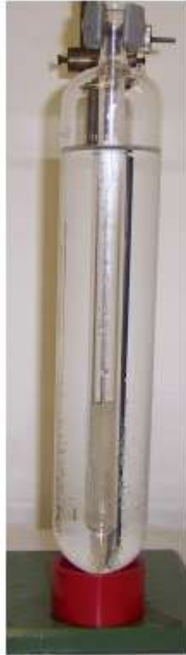
Figura 1. Celda de punto triple del agua del Instituto Nacional de Metrología, INM
