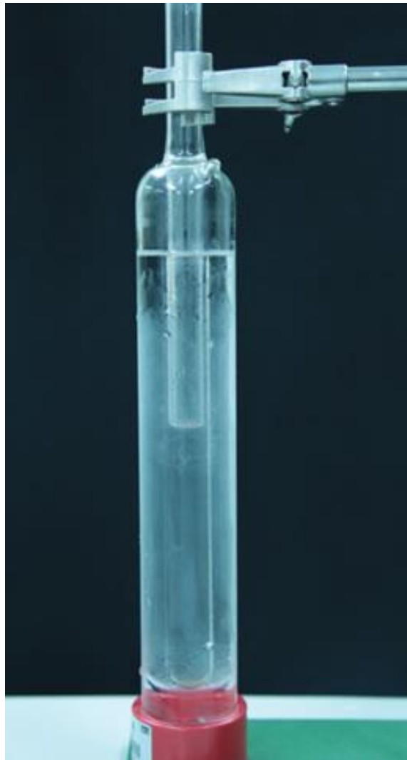
Figura 1. Celda de Punto Triple del Agua, Imagen de http://inm.gov.co/index.php/sala-prensa/noticias/241-reconocimiento-mundial-a-mediciones-inm , recuperada el 2015-12-28
