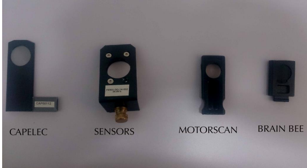
Figura 3. Foto de diferentes tipos de geometrías de los filtros utilizados para la calibración de opacímetros
